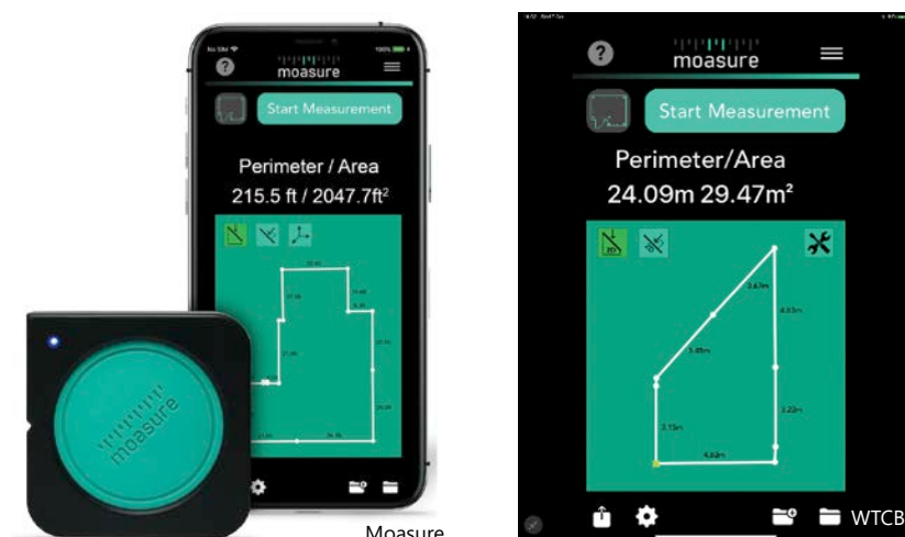
2 | Opmeten en visualiseren van de oppervlakte van een buitenkoer met de 'Moasure'-applicatie en de bijhorende externe sensor ($ 300 in 2019).
