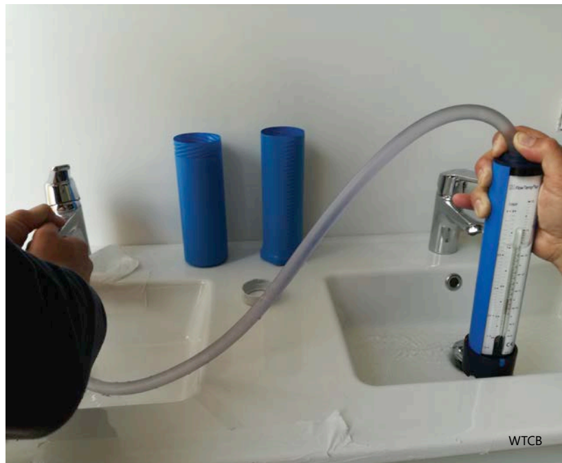
2 | Meting van het spoeldebiet aan een tappunt.
