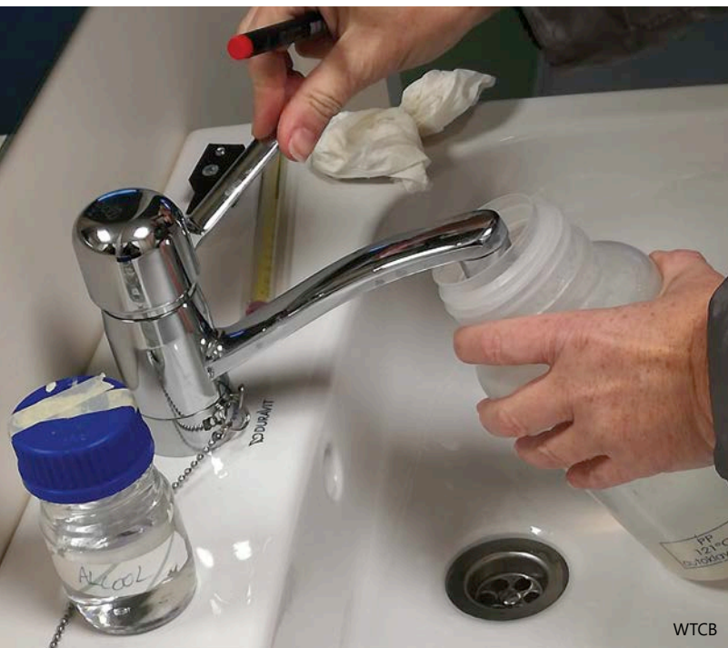
1 | Staalname aan een wastafel na de spoeling.
