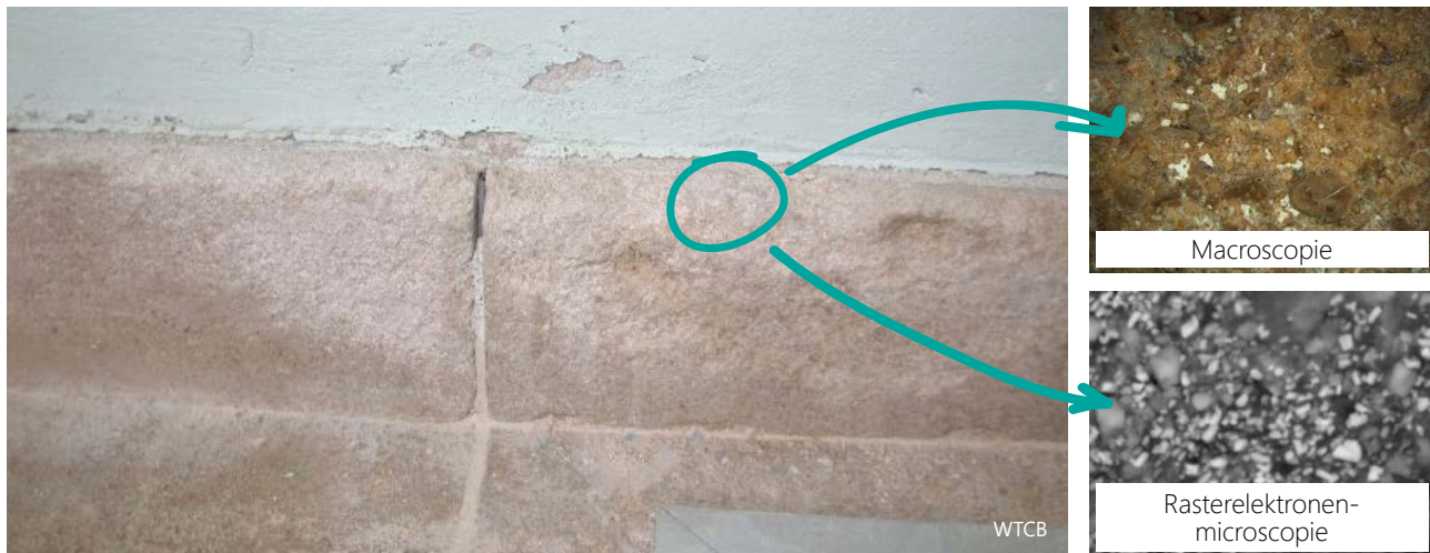
4 | Capillaire steen die verweerd is door de vorming van zout (NaCl).
