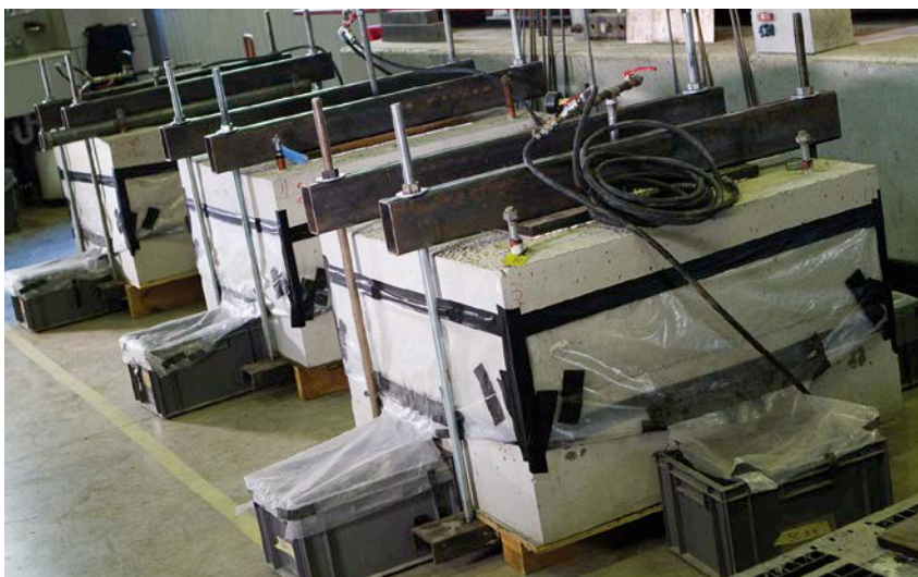
2 | Waterbelasting door een waterkolom van 3 m en opvolging van het lekdebiet.
