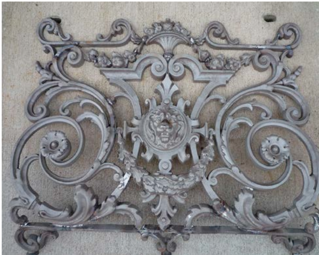
2 | Voorbeeld van een complexe gietijzeren vorm waarvoor zandbed- printen een uitkomst kan bieden
