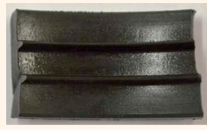
3 | Met siliconen ingesmeerd EPDM na de proef
