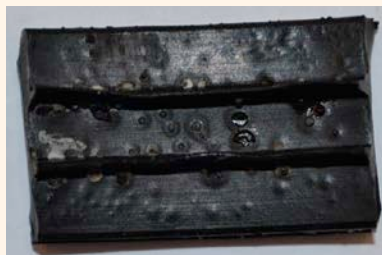
2 | Met vet ingesmeerd EPDM na de proef
