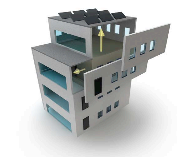
1 | Renovatieprincipe waarbij er gebruikgemaakt wordt van geprefabriceerde gevelelementen die op de bestaande muren aangebracht worden
