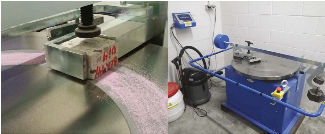
Proefopstelling ter bepaling van de slijtvastheid van betonvloeren volgens Böhme
