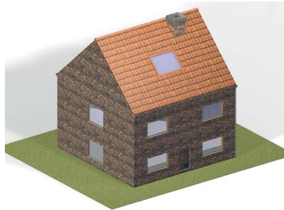
1 | Het feit of de behandeling van het bouwdetail al dan niet rendabel is, werd bestudeerd aan de hand van een viergevelwoning met een metselwerkoppervlakte van 300 m 2 en een gevelvoet van 40 m lang.
