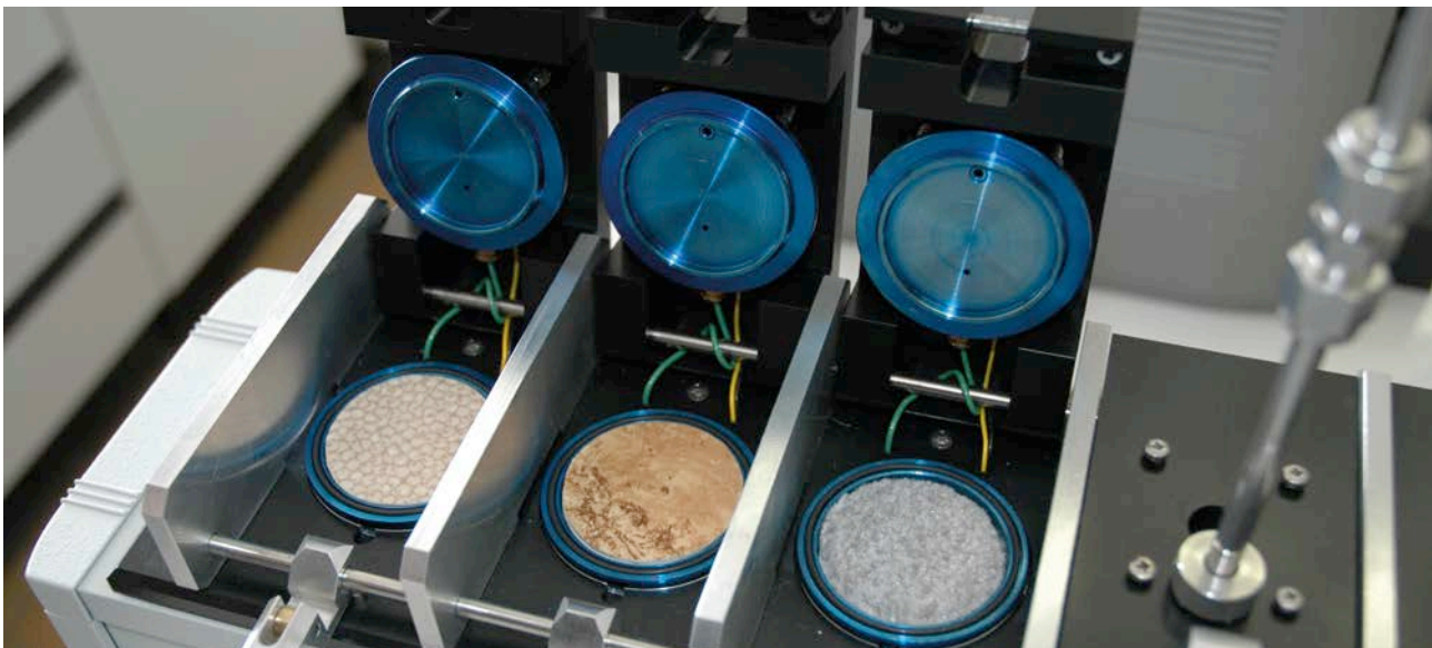
Emissiemetingen op verschillende types vloerbekledingen in het kader van het TAP-project HEMICPD
