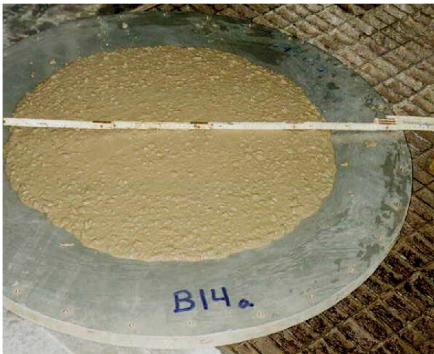
2 | Bij de bestelling van zelfverdichtend beton dient minstens de vloeimaat ( slump flow ) gespecificeerd te worden
