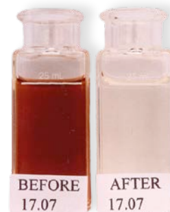
4 | Effect van een actieve koolfilter op bruin regenwater: voor (links) en na (rechts) de behandeling
