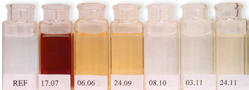
3 | Verkleuring van het water afkomstig van een plat dak met een afdichtingsmembraan
