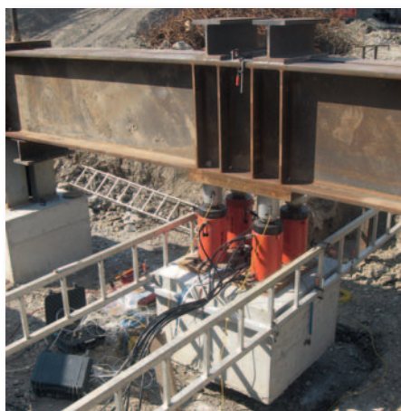
Principeschema van de impulsmethode en voorbeeld van een statische paalbelastingsproef
