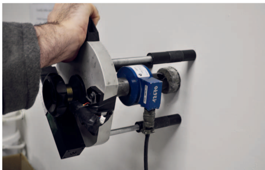
Afb. 4 Afbreekproef volgens de norm NBN EN 1504-2
