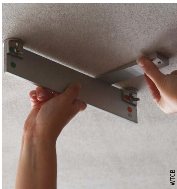
Afb. 2 Controle van de vlakheidstoleranties onder de lat van 20 cm.
