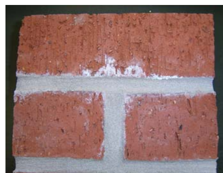
Uitvoering van de proef op de rode baksteen met verschijning van uitbloeiingen (sluier en kristallen).
