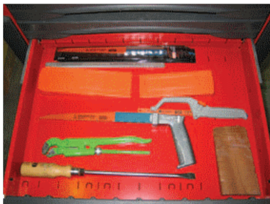
Figuur 5 Gereedschapssets A1 en A2 voor de manuele proef op elementen met inbraakweerstandsklasse RC2.
