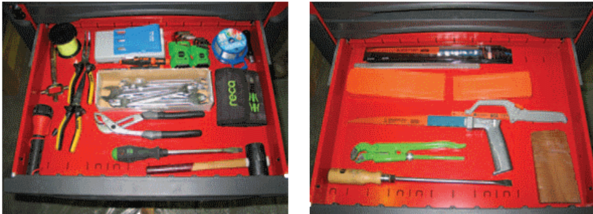
Figuur 4 Gereedschapssets A1 en A2 voor de manuele proef op elementen met inbraakweerstandsklasse RC2.
