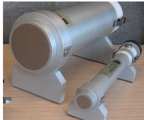
Afb. 1 Bepaling van de absorptiecoëfficiënt \alpha voor loodrechte geluidsinval in de buis van Kundt volgens NBN EN ISO 10534.
